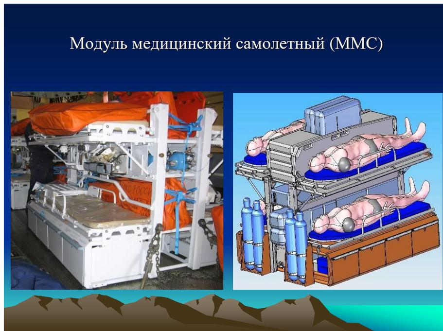
Рисунок 1. Модуль медицинский самолетный (ММС).
