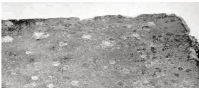
Рисунок 9.5 – Фрактограмма поверхности образца из сплава АМг-3 (х4)
