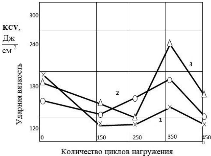
Рисунок 3.8 – Зависимость ударной вязкости Ст3сп (1), ЗТВ (2) и шва (3) от количества циклов нагружения
