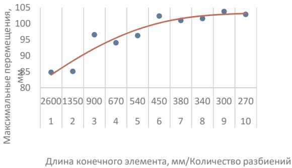
Рисунок 5.10 – Зависимость максимальных перемещений элементов от длины конечного элемента
