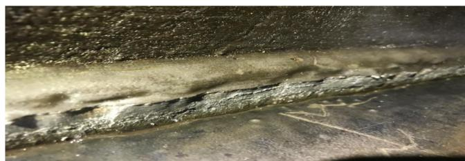
Рисунок 1.11 – Разрушение сварного соединения стенки с днищем резервуара
