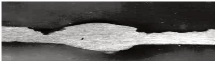
Рисунок 9.4 – Вид поперечного среза сварного шва и з.т.в. образцов из сплава АМг-3 (х10) после экспозиции в подтоварной воде и удаления продуктов коррозии
