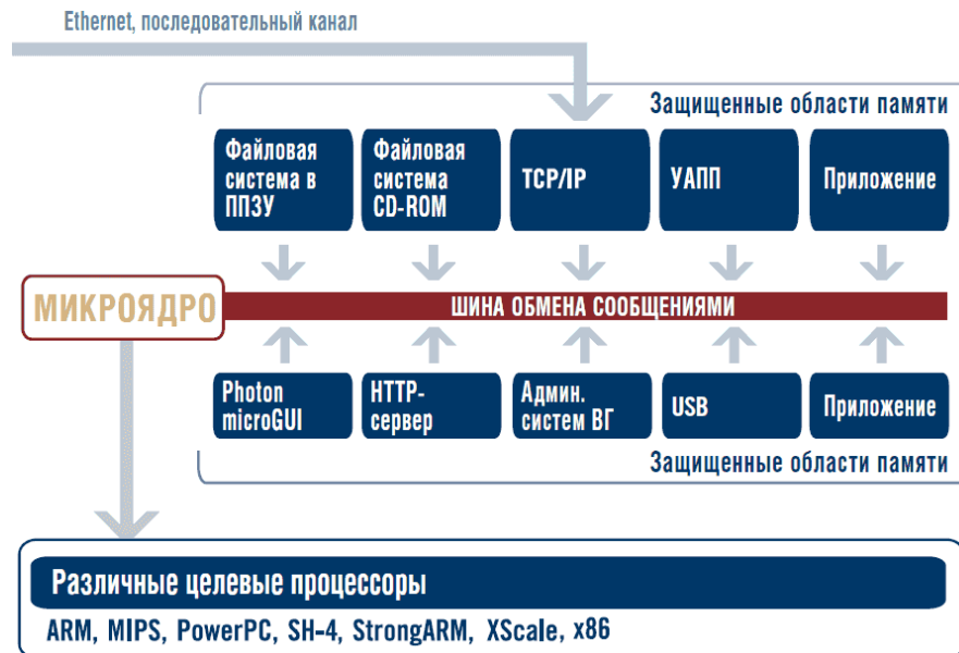
Рис. 14.2. Обмен сообщениями между структурными элементами ОС
