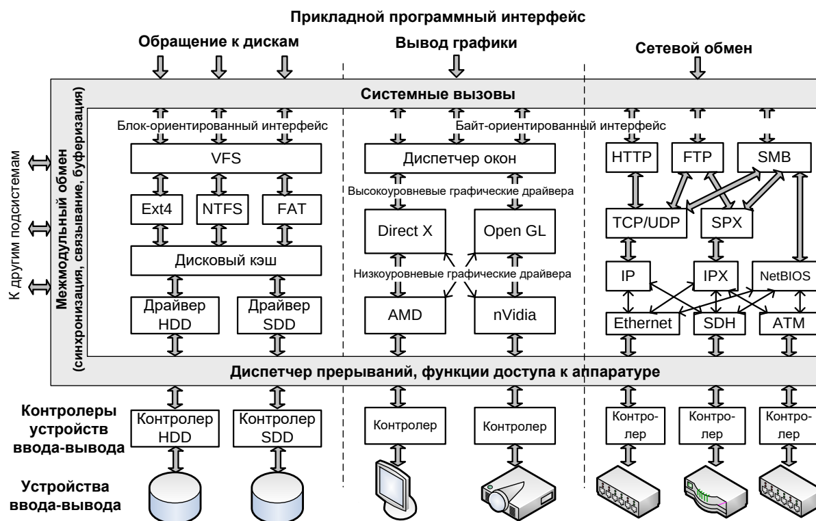
Рис. 5.3. Структура подсистемы ввода-вывода современной ОС
