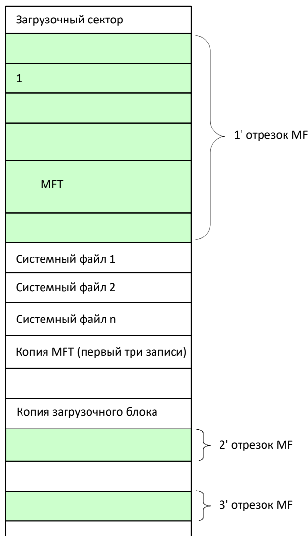
Рис. 7.2. Структура тома NTFS
