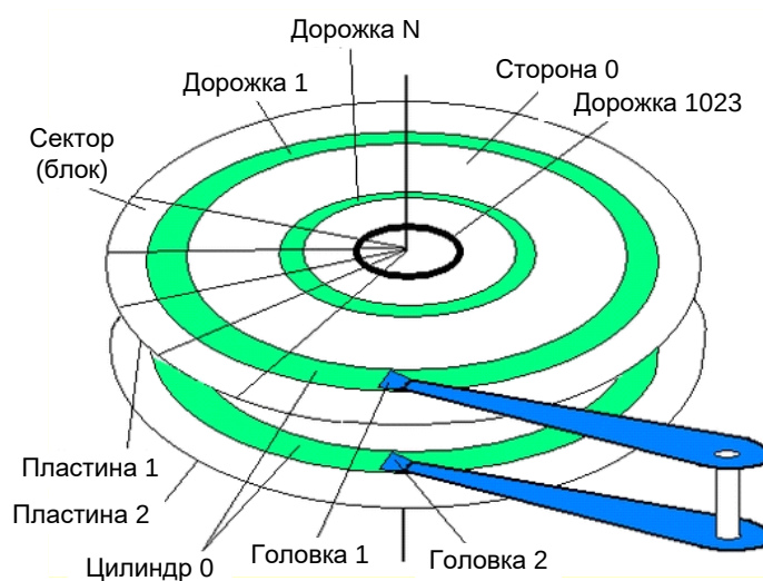
Рис. 6.5. Схема устройства жесткого диска
