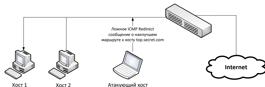
а) Фаза передачи ложного ICMP Redirect сообщения от имени маршрутизатора
