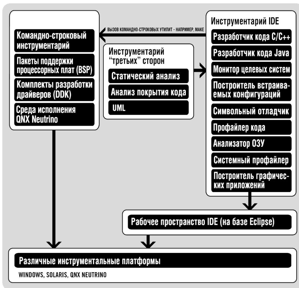
Рис. 14.7. Структура комплекса разработчика QNX Momentics
