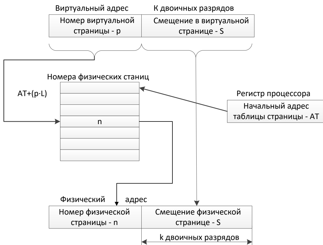
Рис. 3.12. Схема преобразования виртуального адреса в физический
