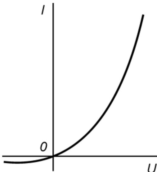
Рис. 3.9. Вольт-амперная характеристика электронной полупроводникового диода
