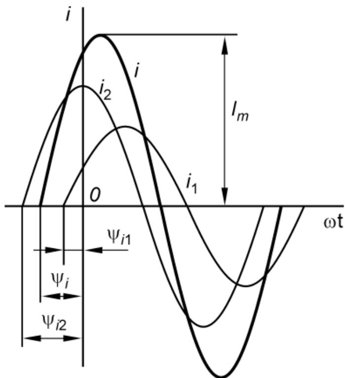
Рис. 4.6. Графическое сложение синусоидальных токов
