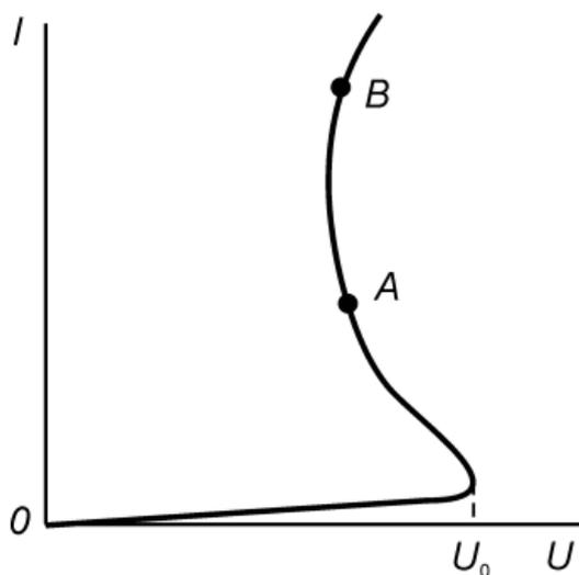
Рис. 3.6. Вольт-амперная характеристика лампы с тлеющим разрядом
