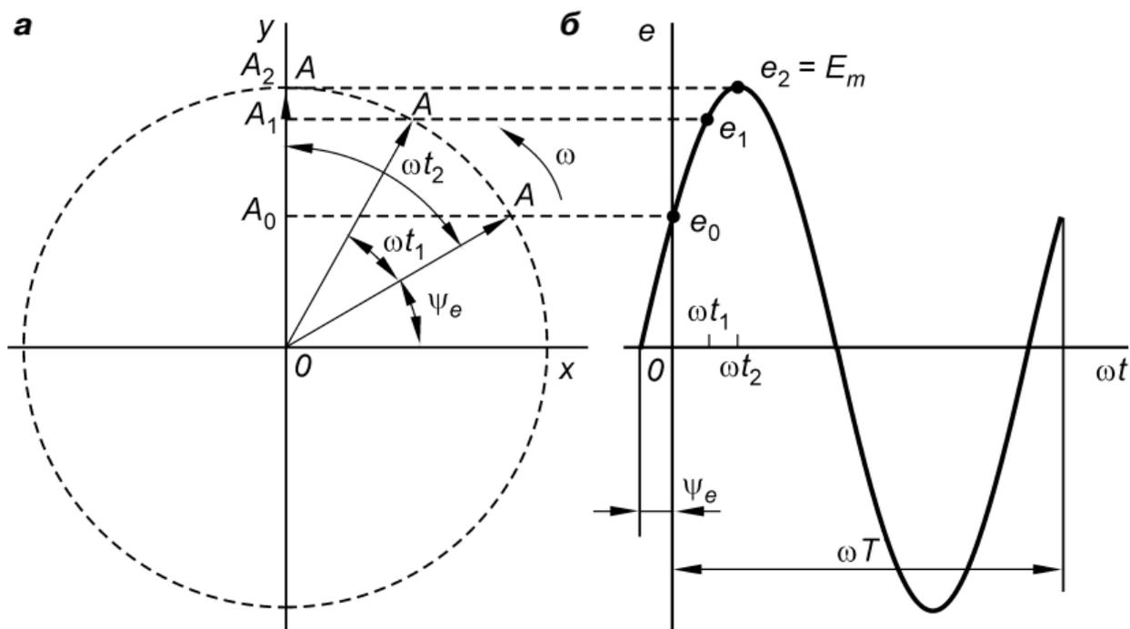
Рис. 5.1. Векторное изображение синусоидальных ЭДС:
