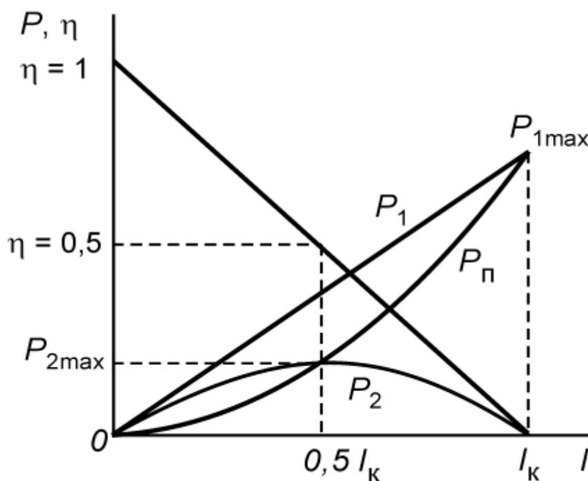
Рис. 7.1. Энергетические зависимости в цепях постоянного тока
