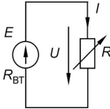
Рис. 1.1. Схема простейшей цепи постоянного тока с переменным сопротивлением электроприемника
