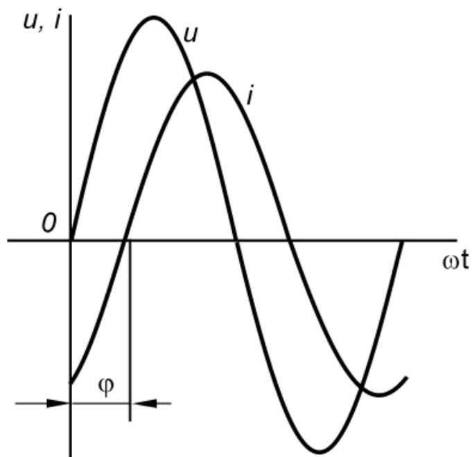
Рис. 4.5. Синусоидальные напряжение и ток, сдвинутые по фазе на  $\varphi$
