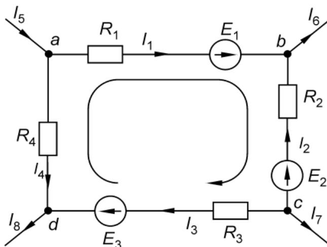
Рис. 2.1. Схема одного контура многоконтурной электрической цепи
