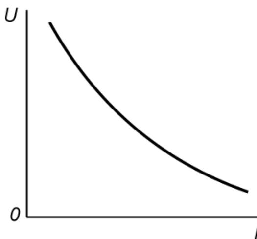
Рис. 3.5. Вольт-амперная характеристика электрической дуги
