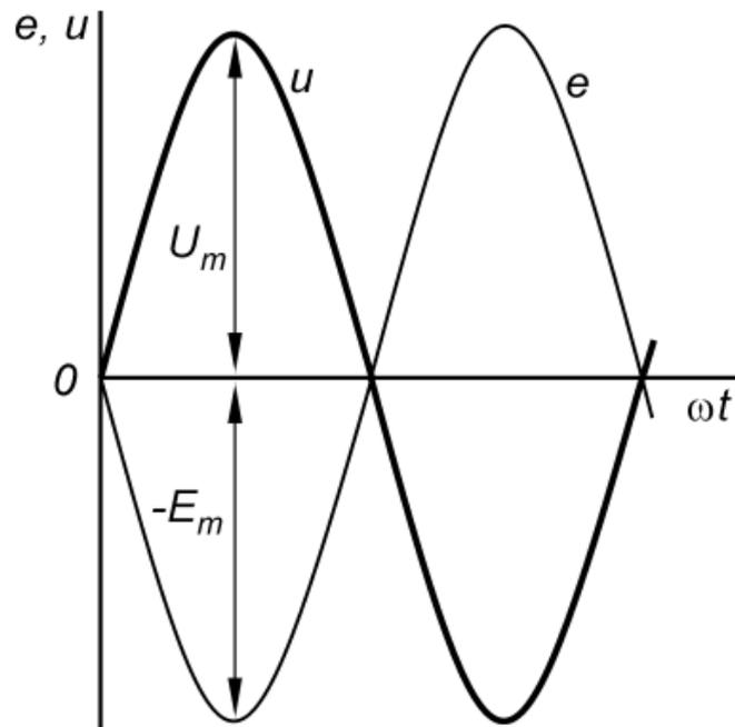
Рис. 4.2. Синусоидальные ЭДС и напряжение, находящиеся в противофазе
