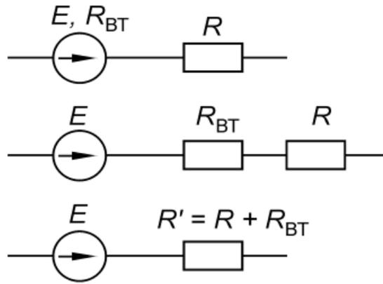
Рис. 2.2. Способы отображения на электрических схемах наличия внутреннего сопротивления источника ЭДС
