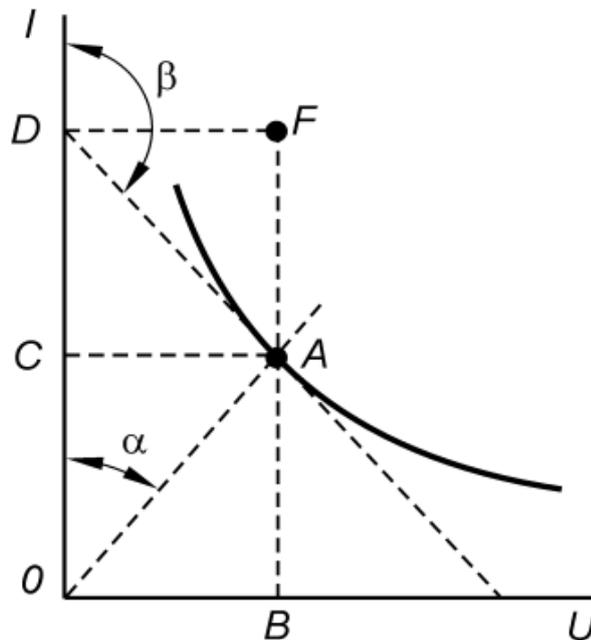
Рис. 3.11. Определение статического и дифференциального сопротивлений нелинейных элементов с обратной зависимостью между напряжением и током
