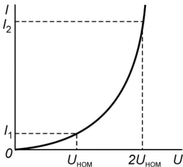
Рис. 3.4. Вольт-амперная характеристика тиритового элемента
