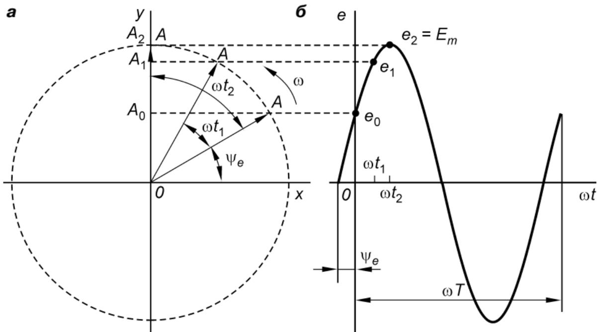
Рис. 6.1. Векторное изображение синусоидальных ЭДС:
