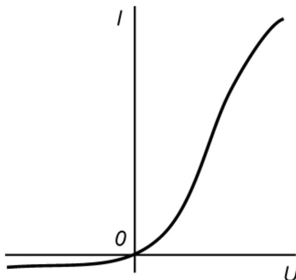
Рис. 3.8. Вольт-амперная характеристика электронной лампы (диода)
