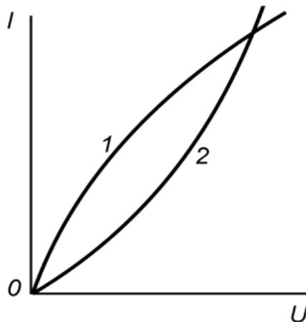
Рис. 3.2. Вольт-амперные характеристики ламп накаливания:
