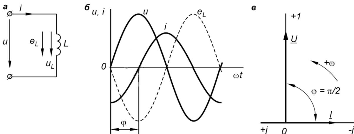
Рис. 9.1. Электрическая схема с индуктивностью  $L$ : а – схема; б – изменение ЭДС самоиндукции, напряжения и тока; в – векторная диаграмма
