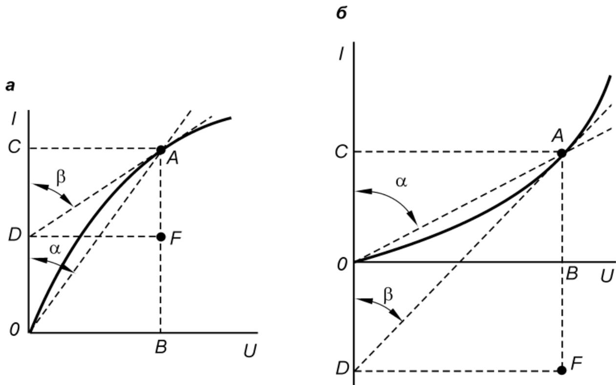
Рис. 3.10. Определение статического и дифференциального сопротивлений нелинейных элементов с монотонно возрастающей зависимостью между напряжением и током: а – с выпуклой вольт-амперной характеристикой; б – с вогнутой вольт-амперной характеристикой
