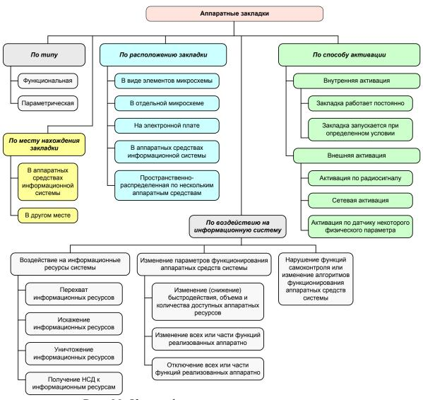
Рис. 20. Классификация аппаратных закладок
