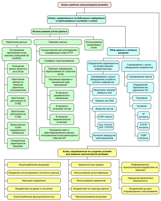
Рис. 12. Классификация атак средств компьютерной разведки [42]
