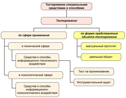
Рис. 6. Классификация тестирования специальными средствами и способами
