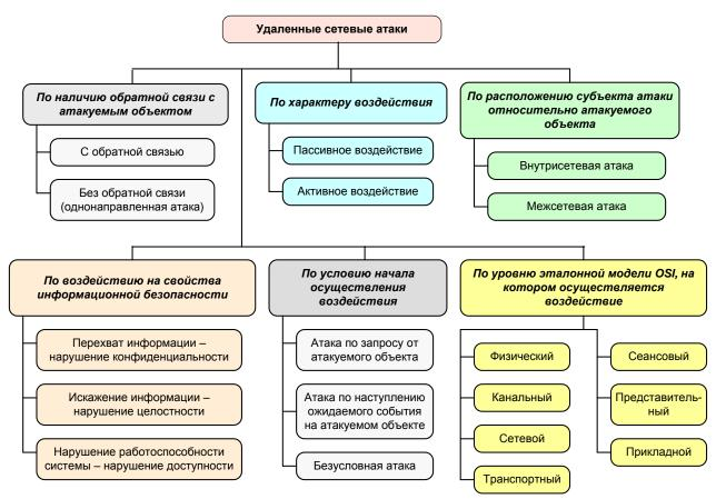
Рис. 15. Классификация удаленных сетевых атак
