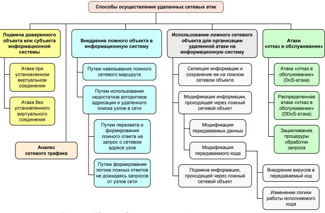
Рис. 16. Классификация способов осуществления удаленных сетевых атак
