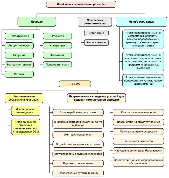
Рис. 11. Классификация средств компьютерной разведки [1]
