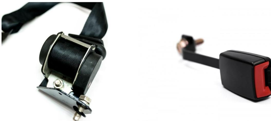
Любой участник дорожного движения (водитель, пассажир) при движении автомобиля должен быть пристёгнут ремнем безопасности. Необходимо вытянуть ремень на необходимое расстояние, так, чтобы пряжка ремня безопасности была зафиксирована в замке. Втягивающее устройство распределит ремень таким образом, чтобы он не провисал, не давил, но плотно прилегал к телу человека.
