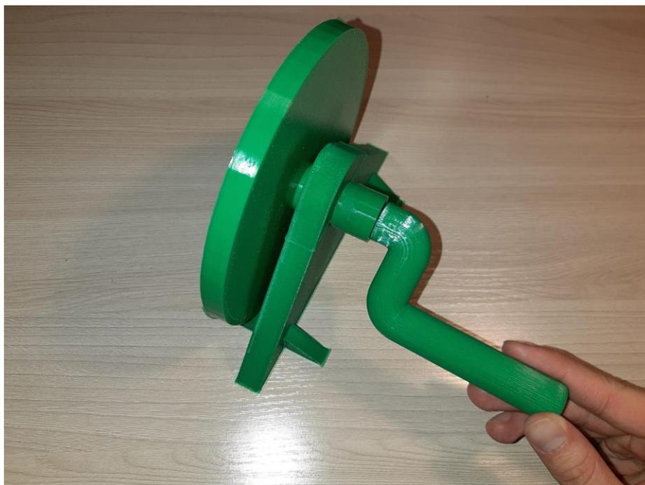
С помощью ручки начинает вращаться диск (подобно колёсному диску на настоящем автомобиле), нажимая на педаль тормоза, диск зажимается с двух сторон колодками (для примера можно сделать сопротивление пальцами), диск начинает вращаться медленнее (скорость машины снижается), и далее происходит полная остановка (диск не вращается, а машина стоит на месте).
