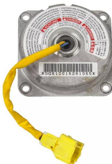
В конструкцию подушек безопасности входит пиропатрон, который наполняет «мешок» подушки безопасности специальным газом. Причём заполнение происходит настолько быстро, что система успевает «поймать» человека. После того как удар произошёл, а подушка выполнила свою задачу – спасла жизнь человека, газ из неё выходит через специальные отверстия.
