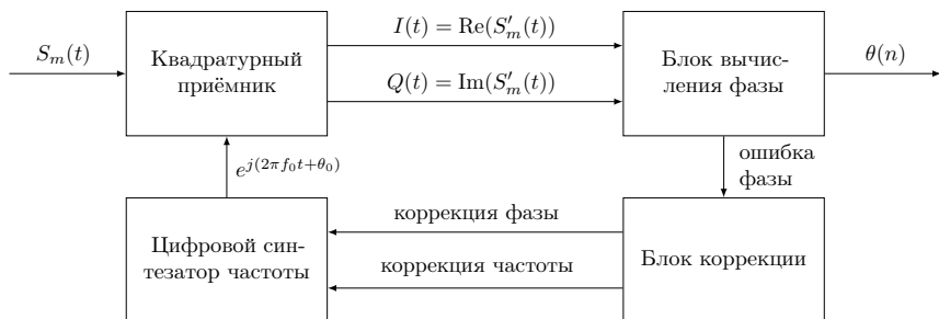
Рис. 12. Структурная схема демодулятора приемника фазоманипулированных сигналов
