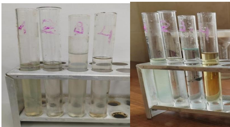
Рисунок 4 – Колба № 1 – вода из пласта + \text{K}_4[\text{Fe}(\text{CN})_6] ; Колба № 2 – вода из пласта + \text{NH}_4\text{SCN} ; Колба № 3 – сепарированная вода + \text{K}_4[\text{Fe}(\text{CN})_6] ; Колба № 4 – сепарированная вода + \text{NH}_4\text{SCN}
