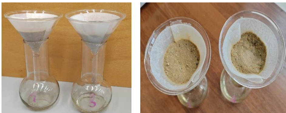
Рисунок 1 – Слева колба с пластовой водой, отделенной от сырой нефти при отстаивании (№ 1), справа колба с водой, после блока водоподготовки на промысле (№ 3)
