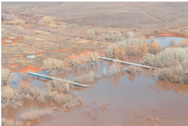
Рисунок 1 – Обследование воздушных переходов в паводковый период с применением БПЛА
