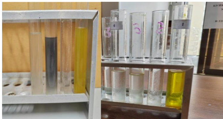
Рисунок 5 – Колба № 1 – вода из пласта + Al_2(SO_4)_3 ; Колба № 2 – вода из пласта + FeCl_3 ; Колба № 3 – сепарированная вода + Al_2(SO_4)_3 ; Колба № 4 – сепарированная вода + FeCl_3
