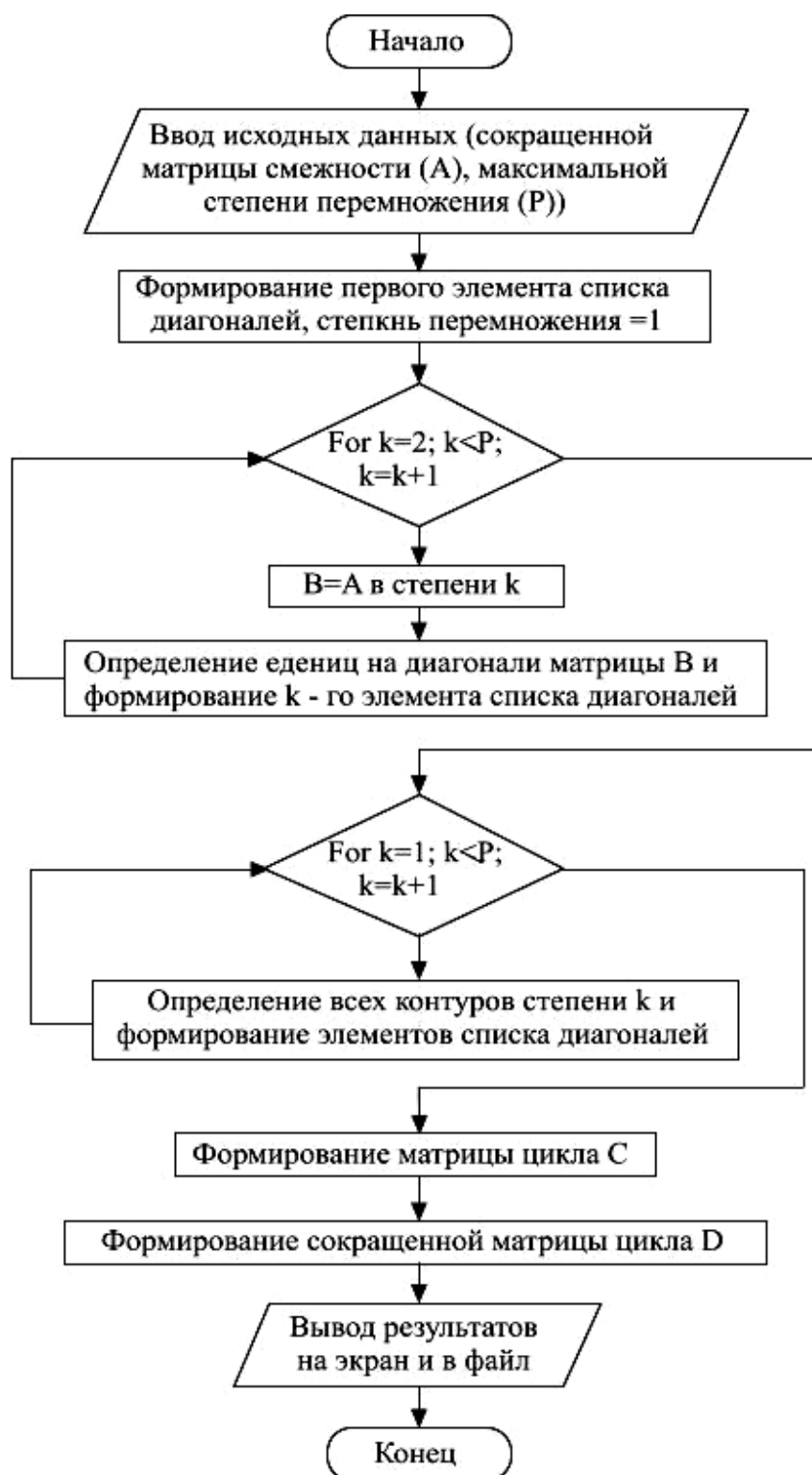
Рис. 2.14 Блок-схема алгоритма структурного анализа сложных теплотехнологических схем
