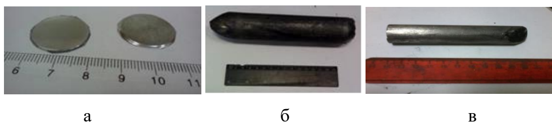
Рисунок 2.3 – Вид образцов, полученных после ИПД: а – после ИПДК, б – после РКУП \varnothing 40 мм, в – после РКУП \varnothing 20 мм
