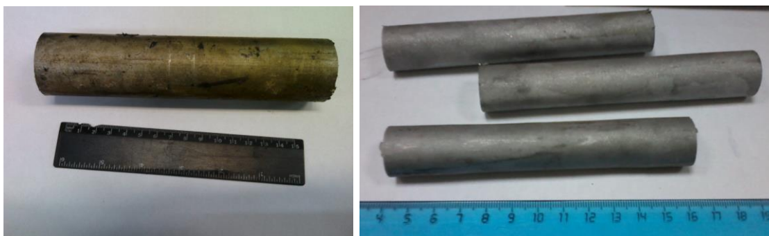
Рисунок 2.2 – Заготовки для РКУП а) Ø 40мм и б) Ø 20 мм
