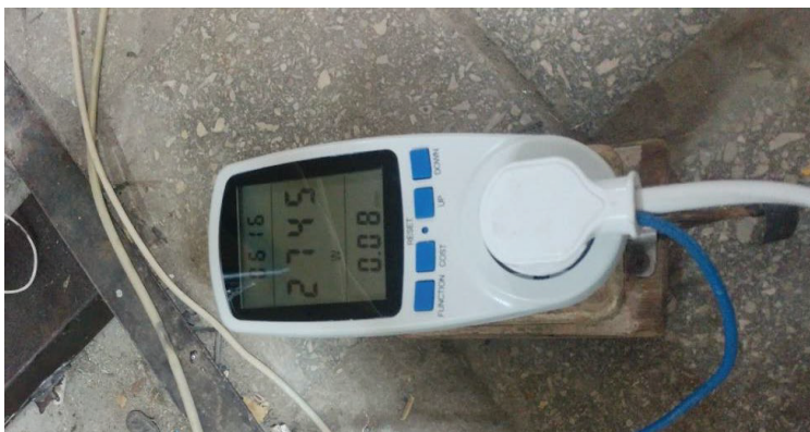
Рисунок 3.3 – Дублирующий энергометр «Feron TM55»
