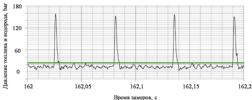
Рисунок 3.9 – Диаграмма впрыска топлива в ДВС специального автотранспорта при давлении подачи водородной примеси 0,2 МПа
