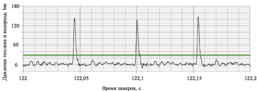
Рисунок 3.10 – Диаграмма впрыска топлива в ДВС специального автотранспорта при давлении подачи водородной примеси 0,25 МПа
