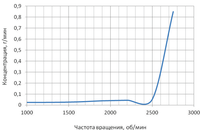
Рисунок 1.16 – Зависимость средних значений выбросов \text{HC} для двигателя Tector 4, установленного на автомобиле Iveco EuroCargo, мощностью 160 л.с. в режиме без нагрузки от частоты вращения коленчатого вала
