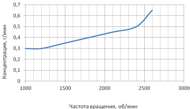
Рисунок 1.13 – Средняя зависимость выбросов СО от частоты вращения коленчатого вала двигателя Tector 4, мощностью 160 л.с., установленного на автомобиле Iveco EuroCargo в режиме нагрузки
