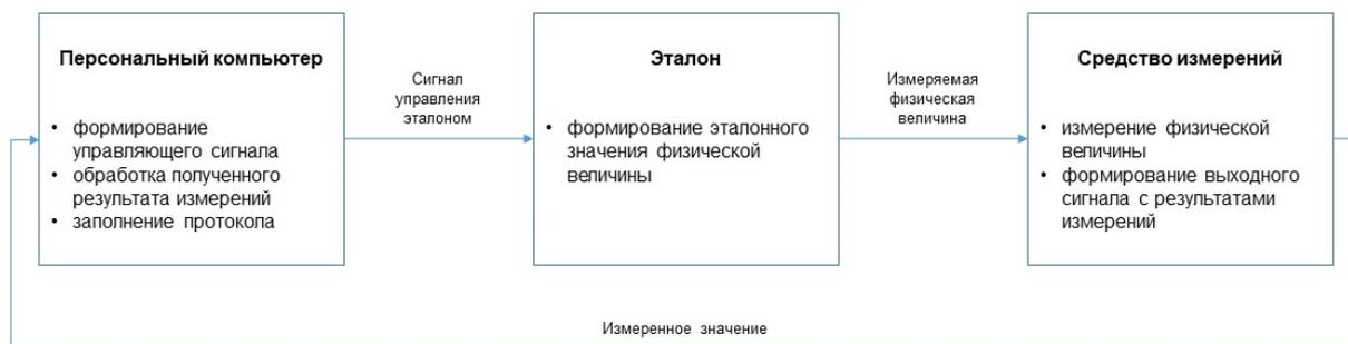
*Рис. 1 – Простейшая функциональная схема автоматизации процесса поверки (калибровки) средств измерений*
