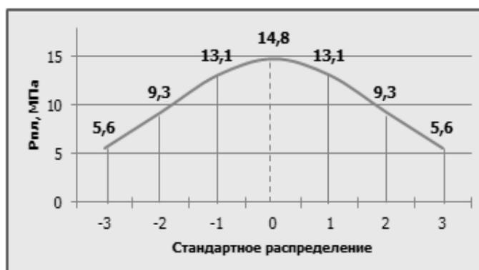
Рис. 3 – Стандартное распределение пластового давления по правилу трёх сигм
