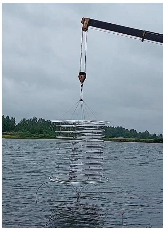
Рис. 2 – Фотофиксация аэратора при проведении натурных испытаний
