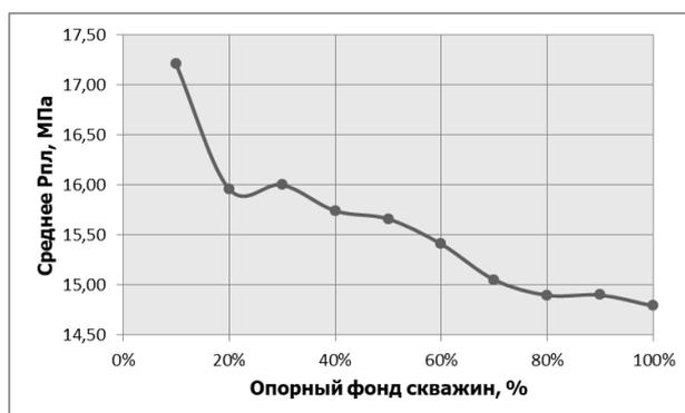
Рис. 1 – Зависимость среднего пластового давления от количества скважин опорного фонда
