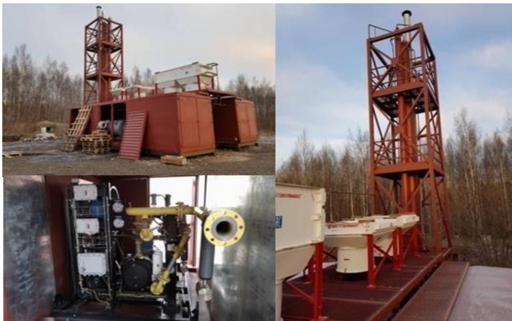
*Рис. 2 – Блок сепарации*
