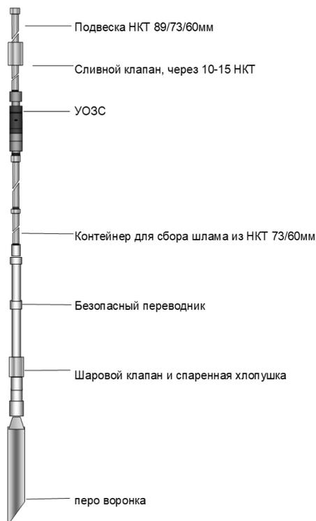
*Рис. 2 – Технологическая схема спуска в скважину УОЗС*
