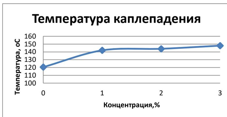
Рис. 2 – График зависимости температуры каплепадения от концентрации присадки
