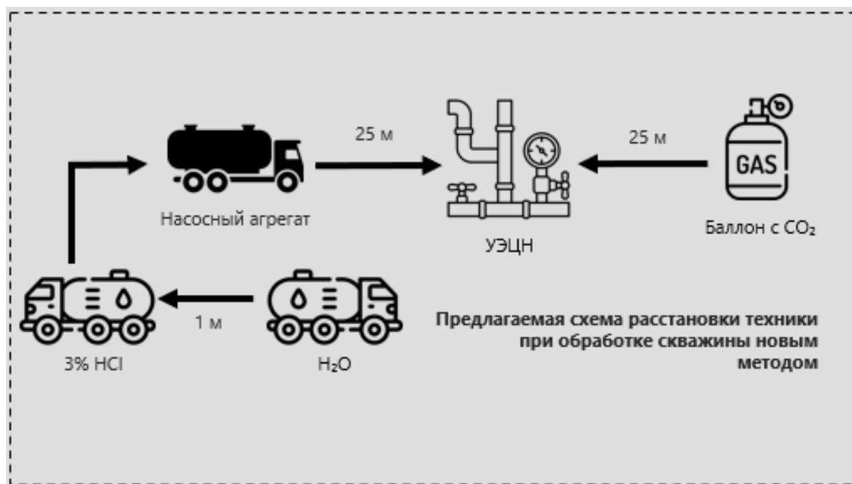
*Рис. 3 – Схема расстановки техники при промывке новым методом*
