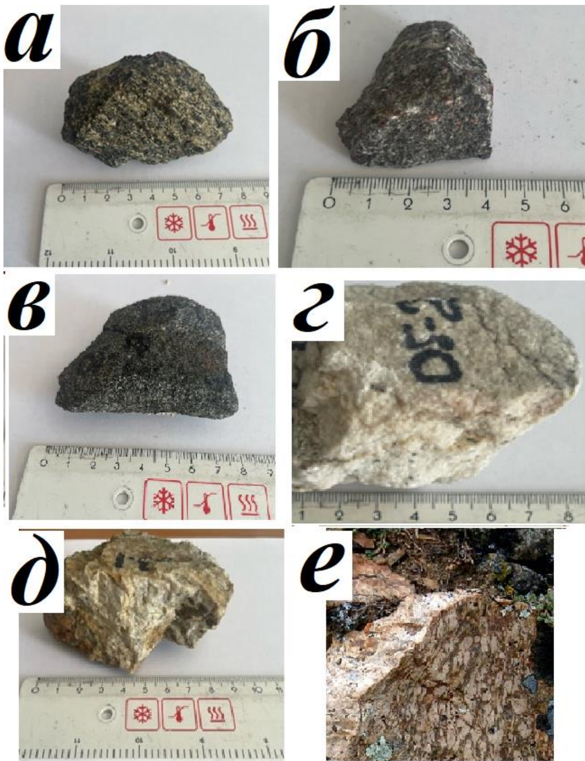
Рис. 1. Породы участка картирования: а – амфиболовый гнейс; б – гранатовый гнейс; в – амфиболит; г – графитизированный мрамор; д-е – пегматит бластокатаклазированный: д – в образце; е – в обнажении
