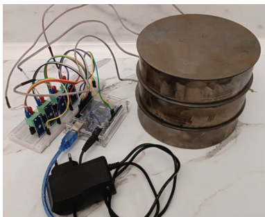
Рисунок 3.2 – Модули MAX6675 , Arduino UNO и термопары, установленные на крышки контейнеров
