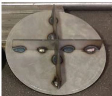
Рисунок 4.8 – Расположение сварных соединений
