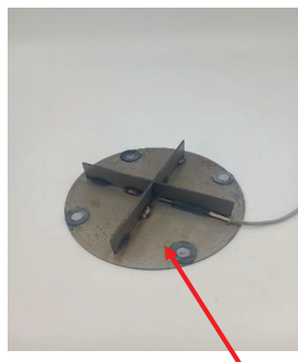
Рисунок 4.11 – Точка измерения температур
