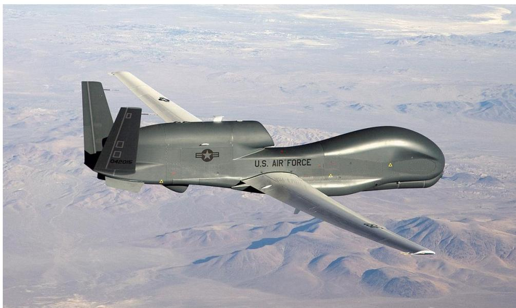
Рис. 3.23. БПЛА RQ-4 Global Hawk
