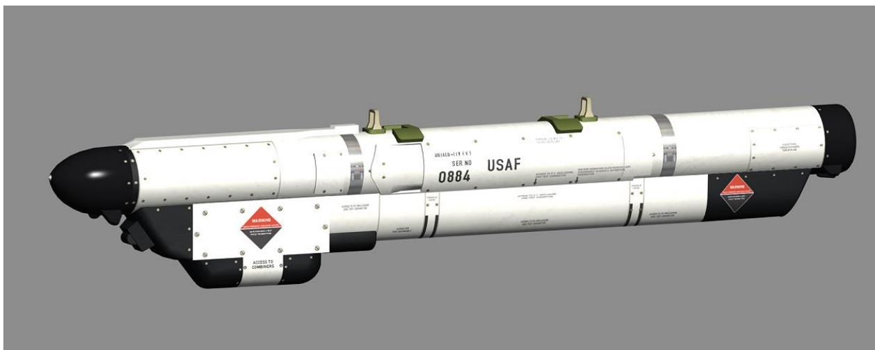
Рис. 3.5. Станция индивидуальной защиты AN/ALQ–119
