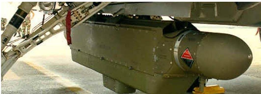
Рис. 3.10. Подвесная контейнерная система РЭП AN/ALQ-131
