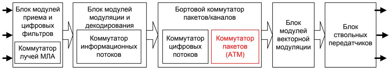
Рис. 1.3 – Схема бортового ретранслятора с ОСБ
