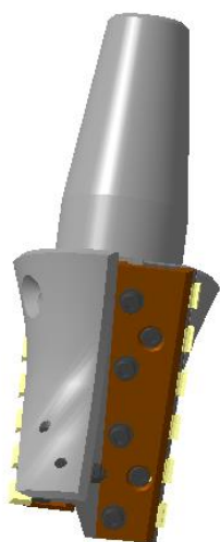
Рис. 1 – Сборная специальная фреза
