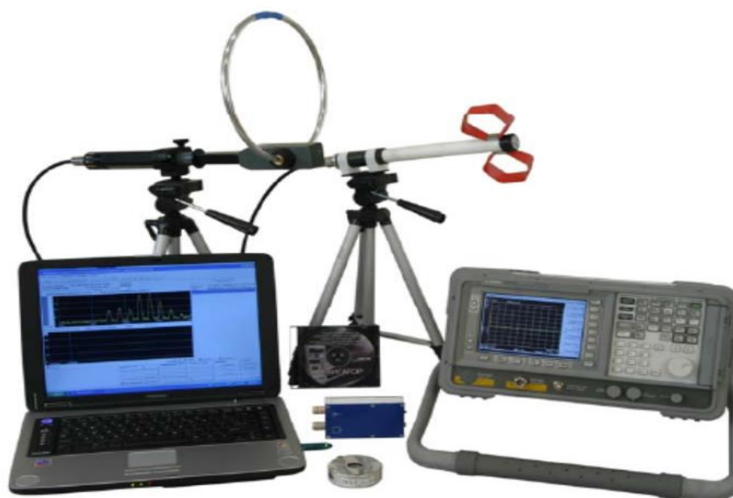
Рис. 3.2. Состав ПАК «Навигатор»
