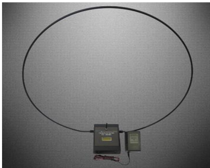
Рис. 4.1. Внешний вид генератора шума ГШ -2500МС
