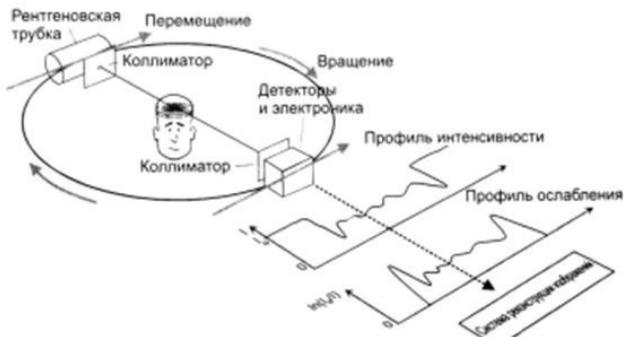
Рис. 4.1. Схема измерений в КТ
