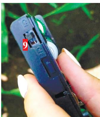
Рис. 20. Съемный блок — кассета со снятой крышкой. Тумблер включения / выключения ловушки (рычажок в положении off / on) (9)
