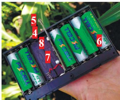
Рис. 19. Съемный блок — кассета со снятой крышкой. Снаружи — сенсор для измерения освещенности среды (4) и плата с двумя светодиодами УФ излучения (5). Внутри — съемные аккумуляторы в качестве источника питания (6 штук) (6), энергонезависимая память (микроконтроллер Attiny 13A) с записанной программой управления светодиодами (7), кнопка для программирования устройства (8)
