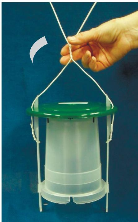
Рис. 11. Закрепление проволочных концов в верхней части ловушки Csalomon® Varl
