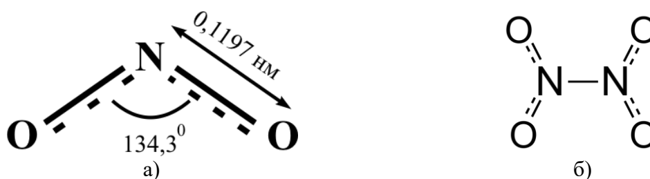
Рис. 3.5 Структурные формулы мономера \text{NO}_2 (а)и димера \text{N}_2\text{O}_4 (б).
