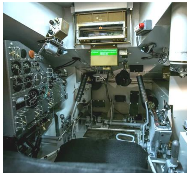
г) ЧМИ рабочего места механика-водителя танка
