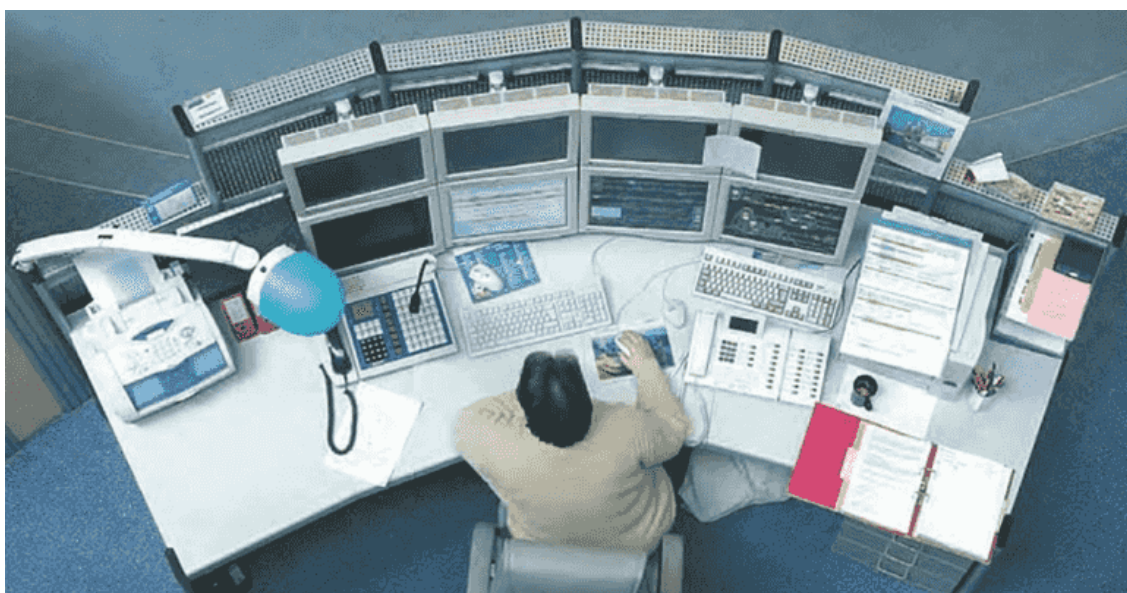
Рис. 3.1. Современный универсальный ЧМИ рабочего места пользователя – совокупность экранов визуализации информации, манипулятора типа «мышь» и клавиатуры
