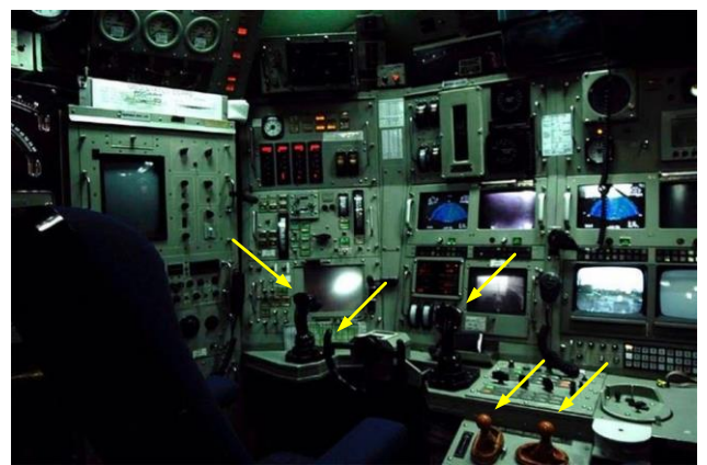
Рис. 3.20. Рычаги управления в составе ЧМИ подводной лодки
