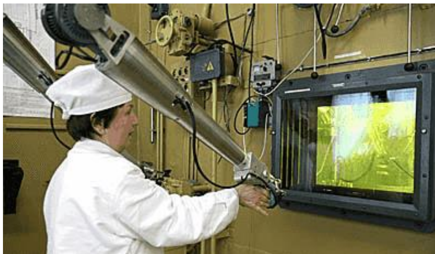
Рис. 3.21. Система копирования движений пользователя для работы с радиоактивными веществами
