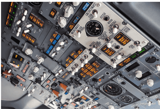
Рис. 3.19. Пульт управления в составе ЧМИ самолета Boeing 737
