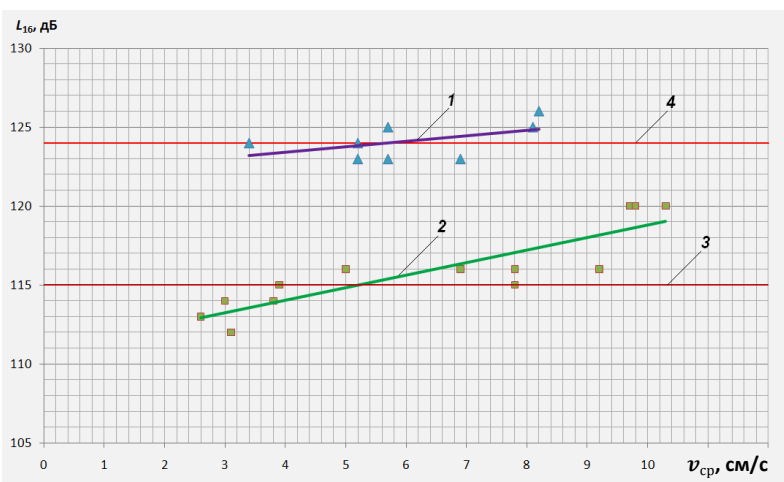
Рис. 5.3 – Зависимость уровней виброскорости L_{16} в октавной полосе 16 Гц от средней скорости внедрения пика v_{cp} при разрушении углецементного блока: 1 – серийный молоток МО-2М ТЭМЗ; 2 – молоток МОД-2 ИГД с виброзащитой, разработанный для угольных шахт Донбасса; 3 – норматив по ТУ; 3 – недопустимый уровень по СН-96
