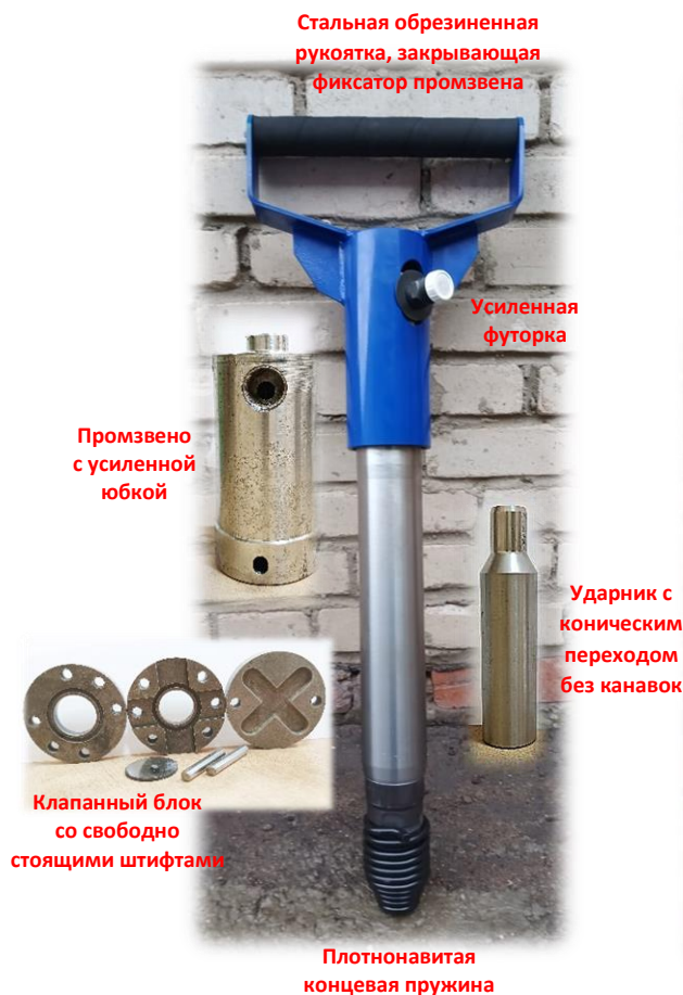
Работа пневматического бетонолома БК-2, модернизированного в ООО «УДАРМАШ» 15,4 кг, 75 Дж, 15,5 с -1 , 1240 Вт
