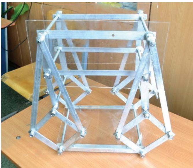
Рисунок 1. Четыре механизма Липкина с платформой из оргстекла
