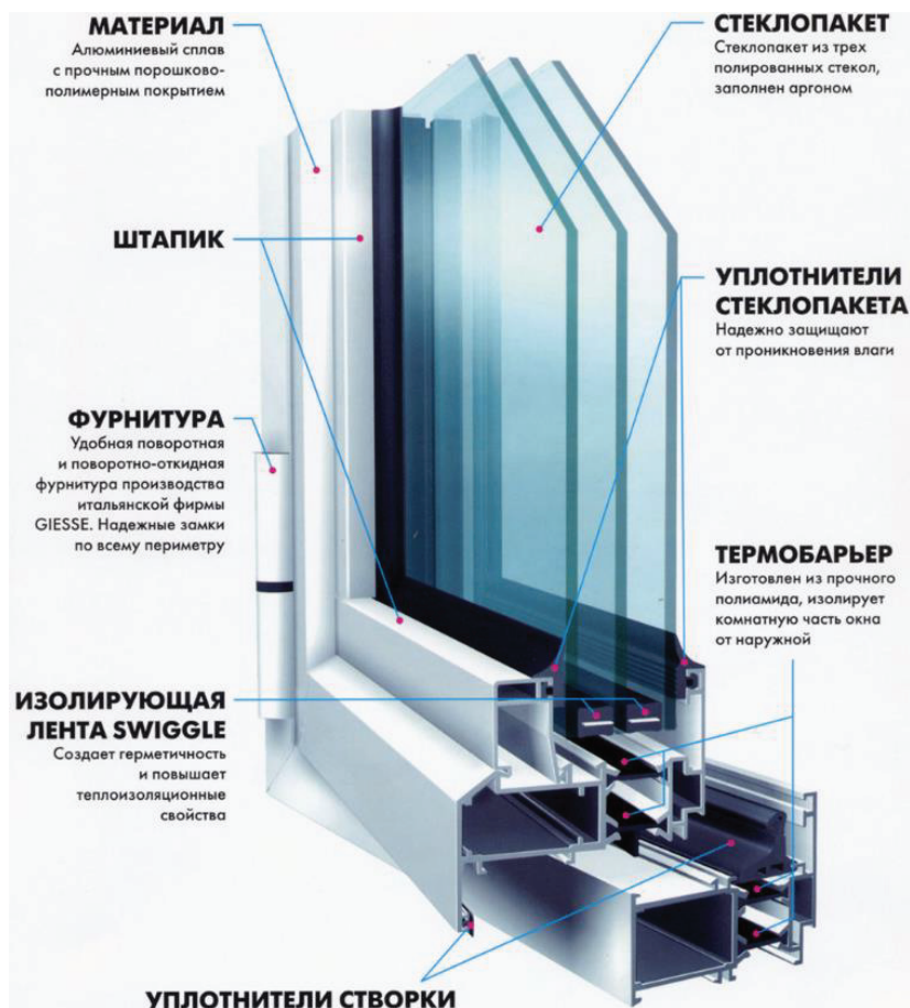
Рисунок 3.17 — Конструкция окна с «теплым» алюминиевым профилем
