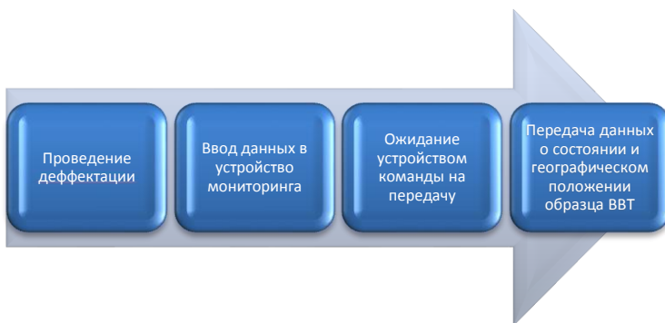
Рис.2. Схема работы устройства мониторинга подвижных объектов.
