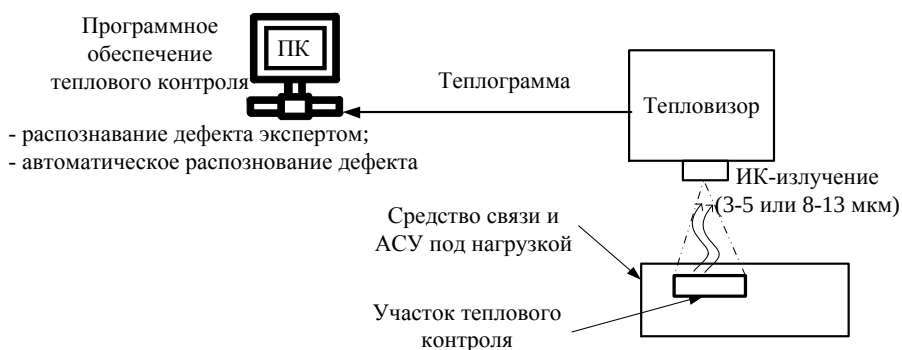
Рис. 1 - Схема теплового контроля средства связи и АСУ
