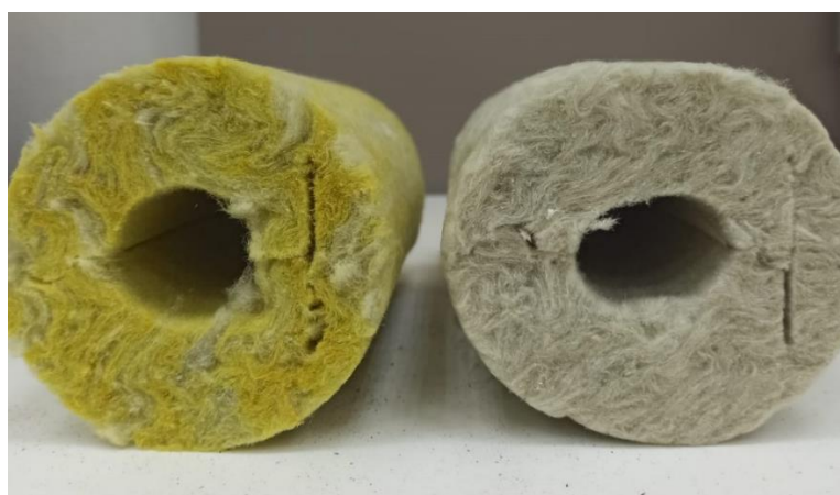
Рис. 3.12 Теплоизоляционные цилиндры Экоролл плотность 80 \text{ кг/м}^3 , слева – новый образец; справа – после 12 часов при температуре 650 \text{ }^\circ\text{C} (связующее полностью выгорело)
