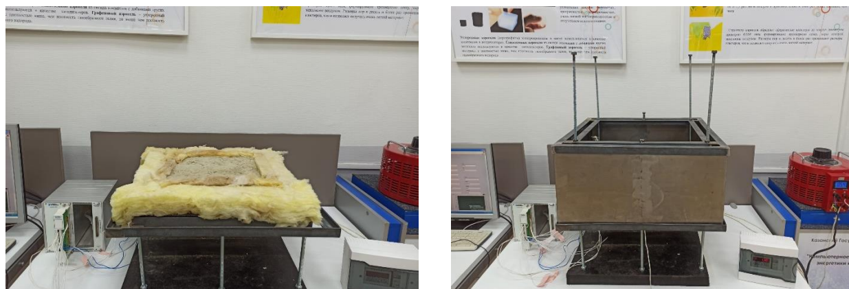
Рис. 3.5 Внешний вид экспериментальной установки для определения теплопроводности теплоизоляционных материалов
