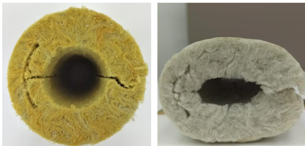
Рис. 3.15 Внешний вид образцов теплоизоляционных цилиндров из базальтового волокна до и после полного выгорания связующего:
