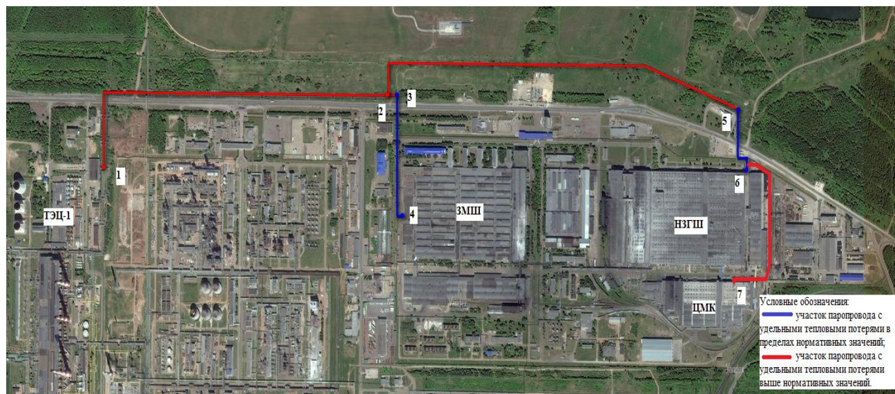
Рис.1.1 Схема пароснабжения паром «30» от Нижекамской ТЭЦ-1 до объектов шинного комплекса ПАО «Татнефть»
