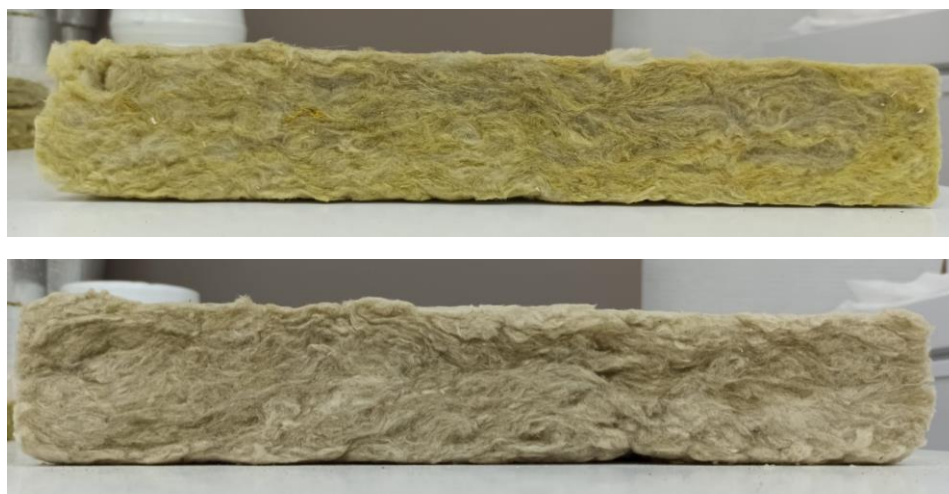
Рис. 3.21 Внешний вид образцов теплоизоляционных цилиндров из базальтового волокна до (верхний) и после полного выгорания связующего (нижний)
