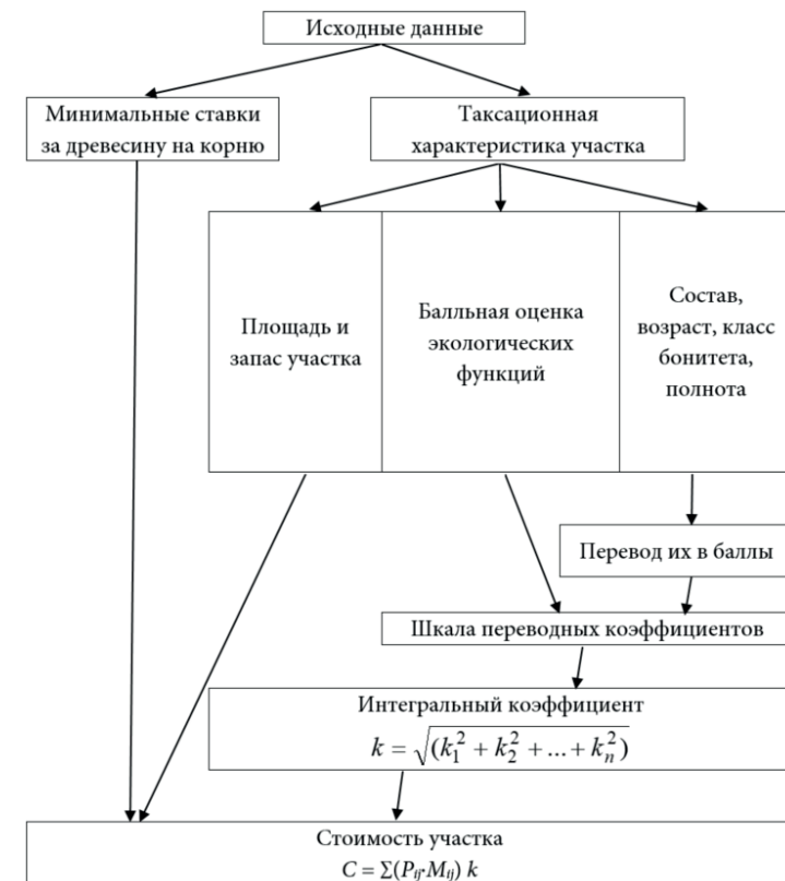
Рис. 12. Блок-схема алгоритма определения эколого-экономической стоимости отдельного участка лесного фонда, покрытого лесной растительностью
