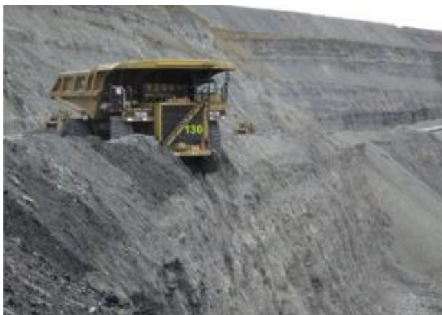
Рисунок 3.21. Сход самосвала с транспортной бермы
