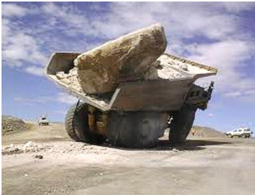
Рисунок 2.54. Неправильная загрузка горной породы в автосамосвалы увеличивает риск возникновения ДТП
