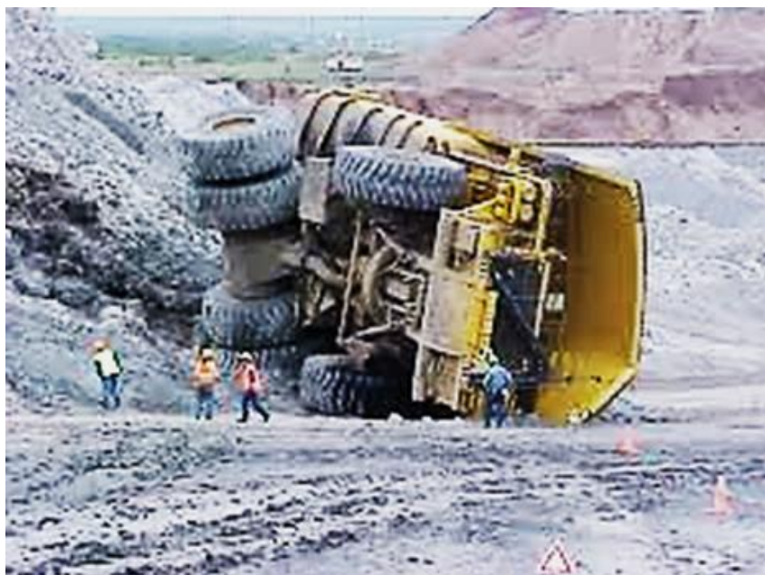
Рисунок 2.50. Недостаточная высота грунтового вала привела к сходу самосвала с дороги
