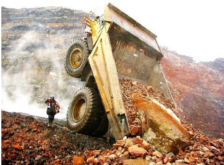
Рисунок 2.51. Опасные условия разгрузки самосвала с отвала по причине отсутствия предохранительного вала
