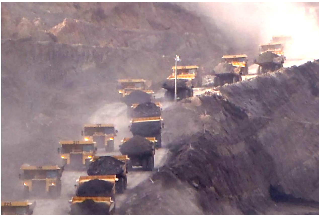
Рисунок 2.52. Недостаточная ширина проезжей части и отсутствие ориентирующего грунтового вала значительно снижают безопасность движения
