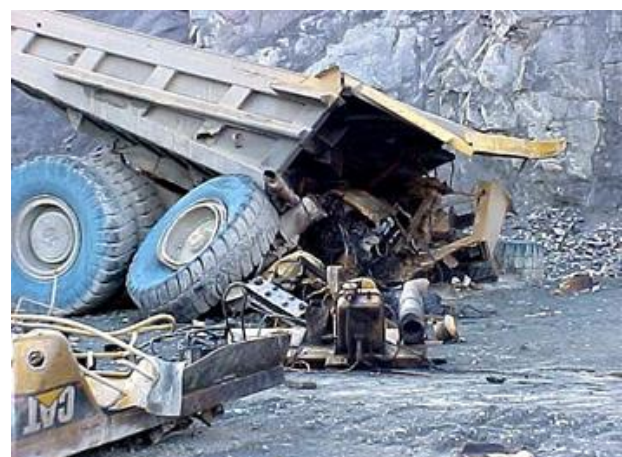
Рисунок 3.21. Сход самосвала с транспортной бермы
